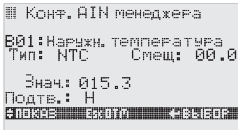
Рис. 5-12 Конфигурация аналогового входа
