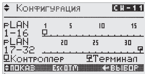
Рис. 5-3 Тест pLAN-среды (Master/Slave)
